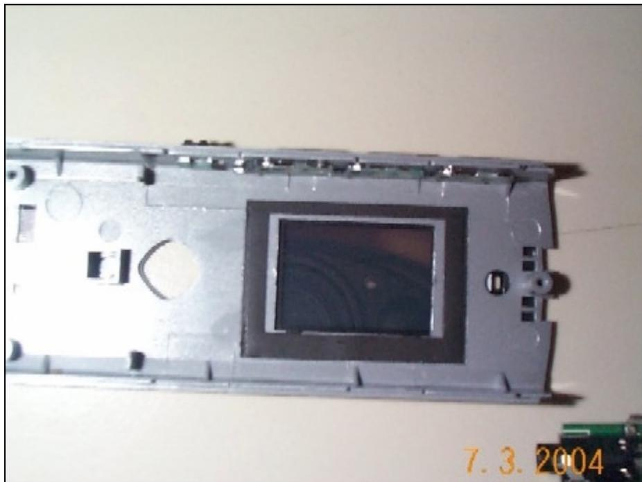
On peut voir que le passage pour le joystick est un des gros points noirs de ce boîtier. En plus des entrées et sorties Jacks, il sera une belle ouverture sur l'extérieur et donc sur la poussière et l'humidité.
